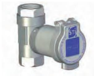
Válvula de 1/4 de vuelta para enclavamiento en posición abierto o cerrado con dos vías de salida o dos vías + purgado.
